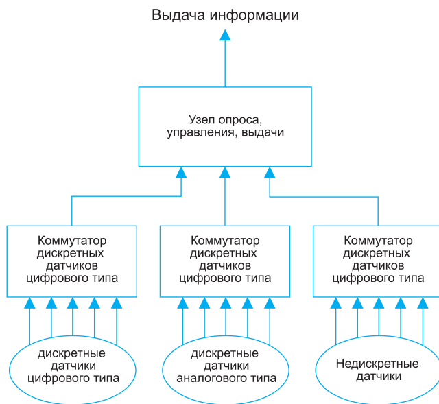
Рис. 1. Пример построения телеметрической системы
